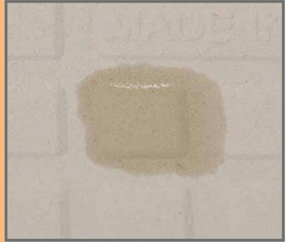
Die Rückseite einer saugenden Steingutfliese: der Wassertropfen wird sofort aufgesaugt.
