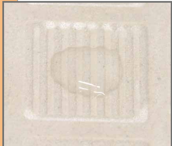
Die Rückseite einer schwach saugenden Steinzeugfliese: der Wassertropfen bleibt stehen.
