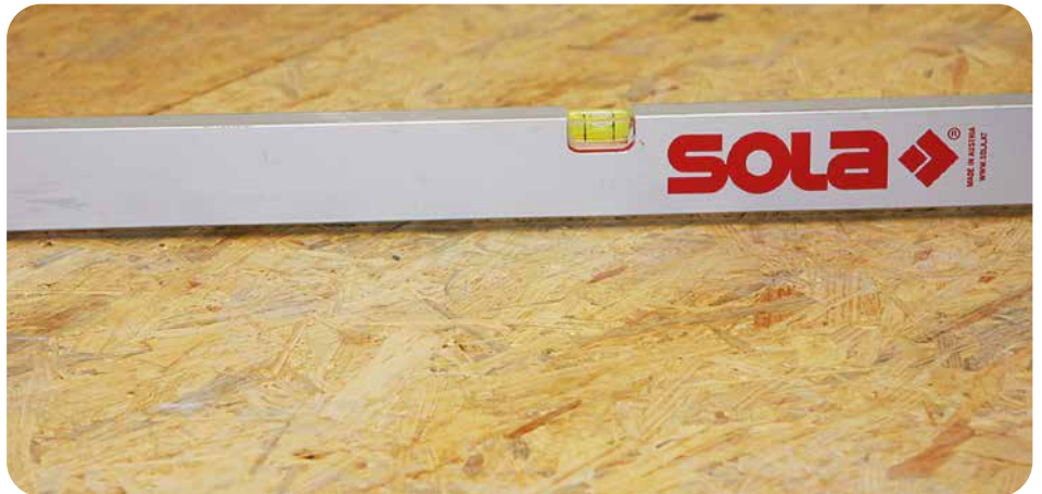
3 Die Ebenflächigkeit des Untergrundes wird mittels Wasserwaage oder Richtlatte beurteilt.
