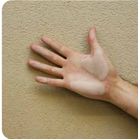
1 Das Absanden des Untergrundes wird mit der Handwischprobe beurteilt.
